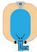
Çalışma Şartlarındaki Tank Görünümü
